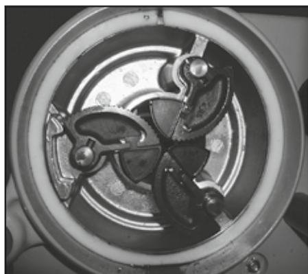
Fig. 4: Vorderes Spannfutter (19) Fig. 4: Front chuck (19) Fig. 4: Mandrin avant (19) Fig. 4: Mandrino anteriore (19) Fig. 4: Mandril de sujeción anterior (19) Fig. 4: Voorste spanklaauw (19) Fig. 4: Främre spännchuck (19) Fig. 4: Fremre spennchuck (19) Fig. 4: Forreste patron (19) Kuva 4: Etuistukka (19) Fig. 4: Mordentes de aperto anteriores (19) Rys. 4: Przedni uchwyt zaciskowy (19) Obr. 4: Přední sklíčidlo (19) Obr. 4: Predné sklúčovadlo (19) 4. ábra: Első tokmány (19) Sl. 4: Prednji stezni uložak (19) Sl. 4: Prednji stezni uložak (19) Slika 4: Sprednja vpenjalna glava (19) Fig. 4: Mandrina anterioră (19) Fig. 4: Передний зажимный патрон (19) Εικ. 4: Μπροστινός σφιγκτήρας (19) Resim 4: Ön sıkıştırma mandreni (19) Фиг. 4: Преден универсал (19) 4 pav.: Priekinis kumštelinis griebtuvas (19) Att. 4: Priekšējā spīles ietvere (19) Joonis 4: Eesmine pingutuspadrun (19)
