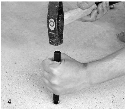
Fig. 6 Pritrditev vložka vrtalne stojke v zid z razcepnim sidrom (sidrni vložki)
