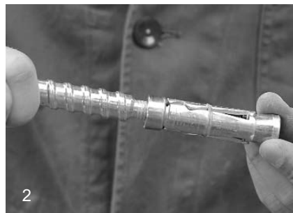
Fig. 6 Pritrditev vložka vrtalne stojke v zid z razcepnim sidrom (sidrni vložki)
